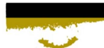
4. Под действием механических напряжений часть слоя накипи скалывается и отделяется от стенки
